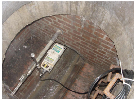
Freispiegelmessung mit Flo-Dar
