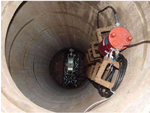
GPRS Durchflusslogger RTQ 500
