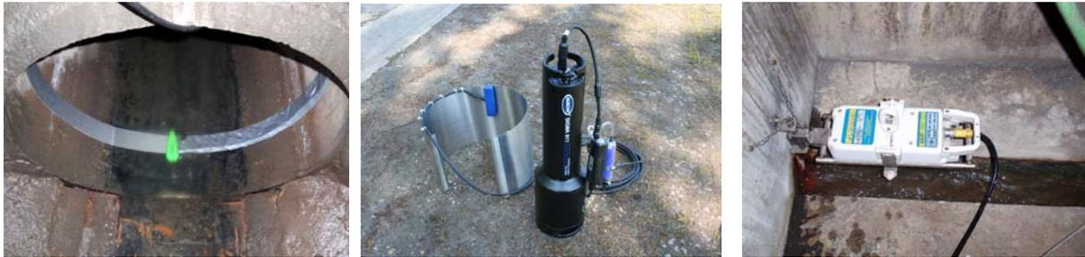
Kombiniert dazu werden **Handmessungen in den Nachtstunden** mit dem **Strömungsmesser FLO-MATE 2.0** durchgeführt.
